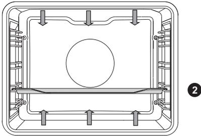
顶部外圈加热器和底部加热器同时工作。
