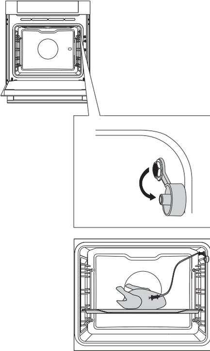
**1** 拧开金属盖 (探针插孔位于烤箱右侧上部)。
