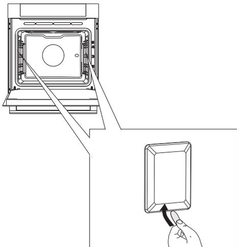
**1** 请用一字螺丝刀撬开并取下灯罩。注意: 小心操作，以免损坏搪瓷内壁。
