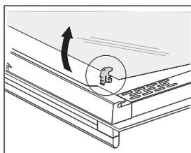
**3** 拆卸第3层玻璃(跟据型号)，缓缓提起，取下。同时，请取下玻璃上的橡胶封。
