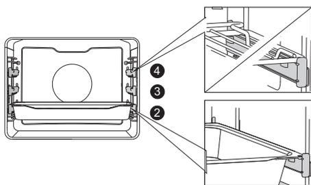
拉出伸缩导轨，将烤架或烤盘放在导轨上，推入烤箱。
