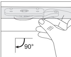
解除禁用请先打开烤箱门，用右手食指向人体一侧波动控制杆。
